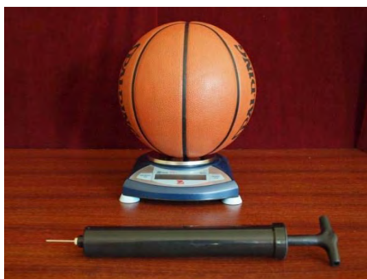
Obr.3.8 Určenie hustoty vzduchu vážením dofúkanovej lopty
